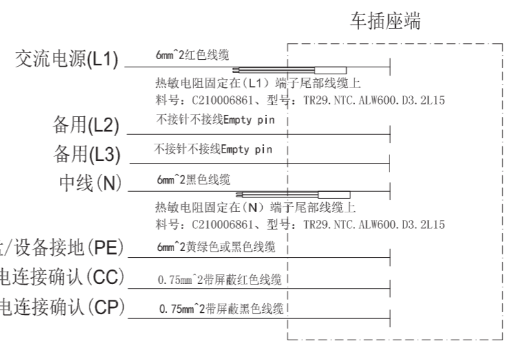
接线方式示意图 Mode of connection
